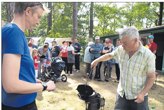
Mit Teamerin Annette Zimmermann (links) führte Experte Axel Ewen den Holzvergaserkocher vor, der aus 1 Watt Lüfterheizung 2500 Watt Wärmeleistung macht, und das nur mit ein paar Kiefernzapfen.
